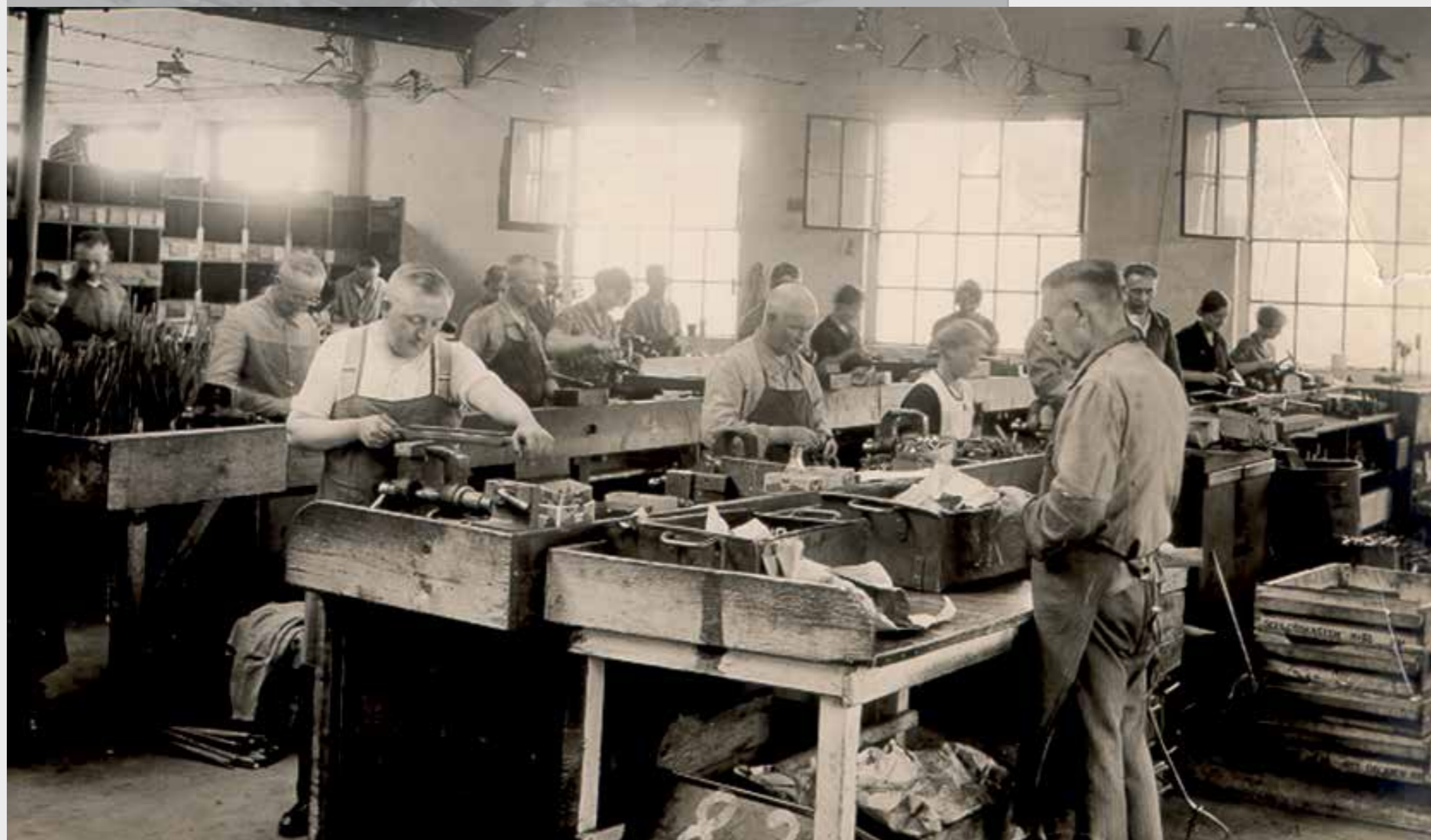
Produktion um 1920. Aufgrund der hohen Ungenauigkeiten im Werkzeugbau mussten viele Teile noch von Hand nachbearbeitet werden
