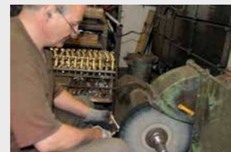
Das Schleifen und Polieren der Beschläge erfolgt in Handarbeit
