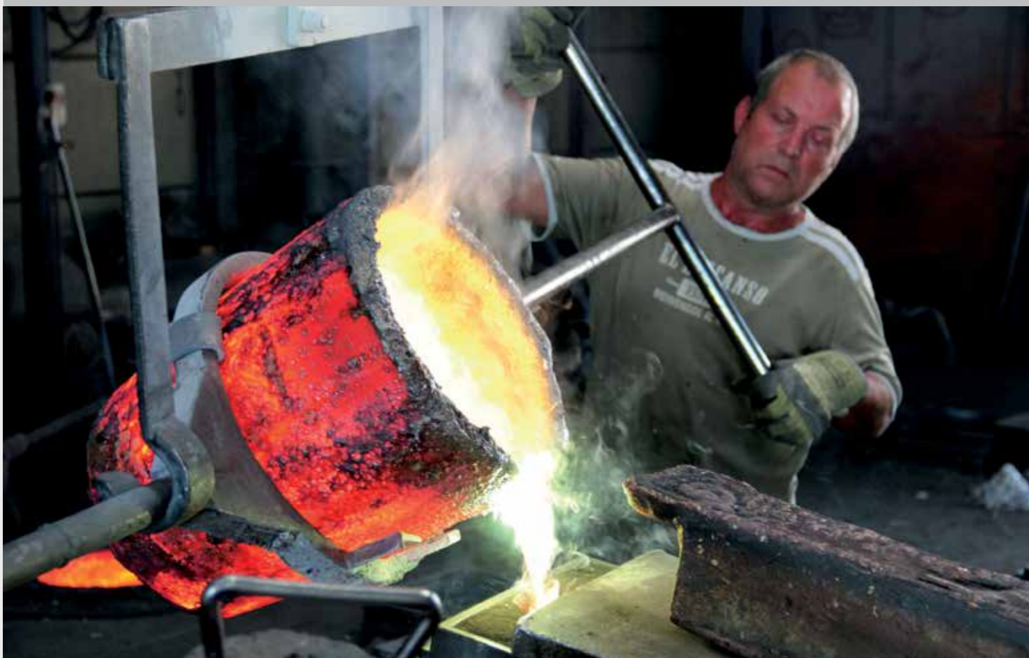
Sandguss und Kokillenguss – traditionelle handwerkliche Techniken – die in der Fertigung von Beschlägen noch immer bedeutend sind
